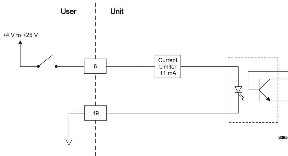
Figure 4-6. DC BIAS/POWER REGULATION (pins 6 and 19)
