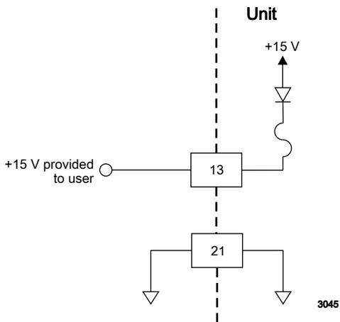
Figure 4-9. +15 VDC (pins 13 and 21)
